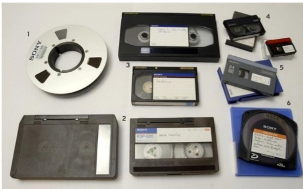
*Diversos tipos de soportes de imagen en movimiento: 1.- Cinta de 1 pulgada; 2.- Videocasetes de U-Matic ¾", estacionario y portátil; 3.- Betacam SP, Estacionario y portátil; 4.- Video8; 5.- DVCAM y miniDV; 6.- XDCAM ). Fuente:*
