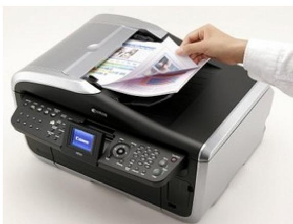
*Escáner Canon PIXMA MP830 con alimentación automática*
